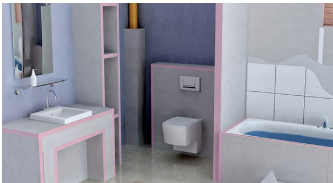
Hotový podklad pod obklady a dlažby
