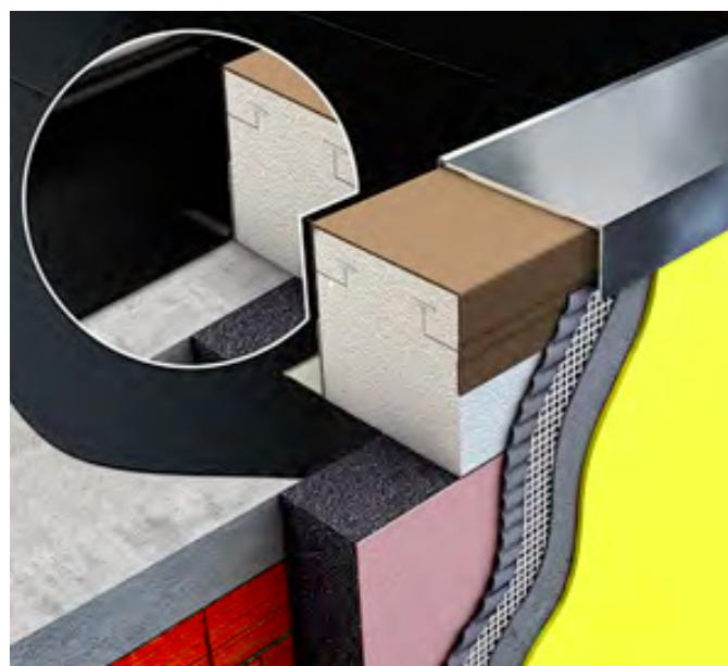
Ak sa prvek lepí na existujúcu parozábranu, musí byť zabezpečená prídržnosť k podkladu. Pri montáži Austrotherm Atikového prvku, ako je znázornené na obrázku, nesmie byť lepená styková plocha (min. 50 % menšia ako prečnievajúca časť (celková hrúbka ETICS)).
