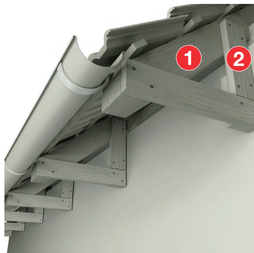
Pomocná konštrukcia z drevených dosiek.
